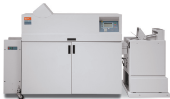
Dispozitiv de legare tip caiet cu margine patrată C.P. Bourg BDFNx
